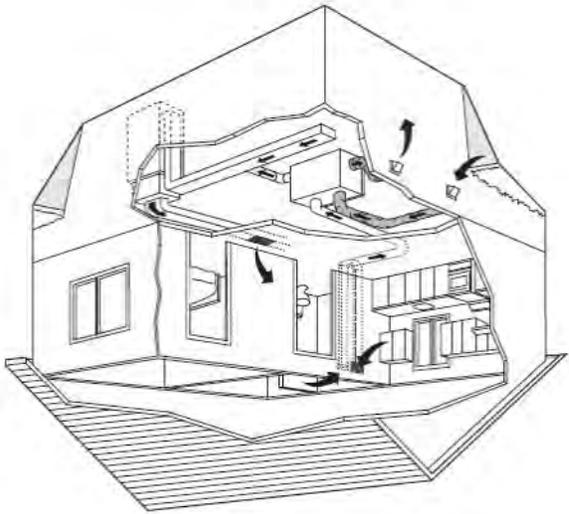
RACCORDEMENTS DIRECTS DU CIRCUIT DE DISTRIBUTION D'AIR DU VRE ET DU CIRCUIT D'AIR EVACUÉ À LA REPRISE D'AIR FROID DE LA FOURNAISE
