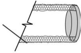
Lorsque vous raccordez la canalisation au collier, prenez note de l'emplacement des vis. Ces vis devraient être placées pas plus loin que 1/2 po du bord extérieur du collier, afin de ne pas entraver le déplacement du registre. 1/2 po
