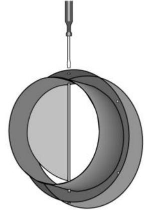
Poussez et tournez avec un tournevis à lame plate. Le registre se bloque automatiquement lorsqu'on relâche la pression.
